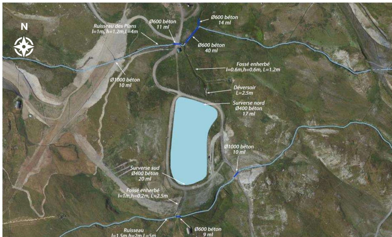
Schéma des exutoires des surverses du lac Echauds 1
